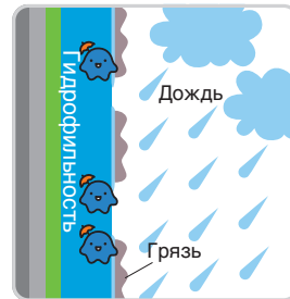
Капли дождевой воды проникают под грязь
